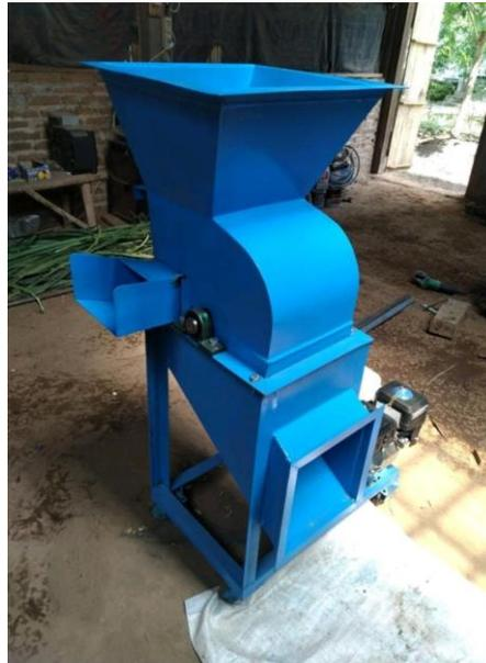
Gambar 3. Mesin penggiling kotoran hewan
