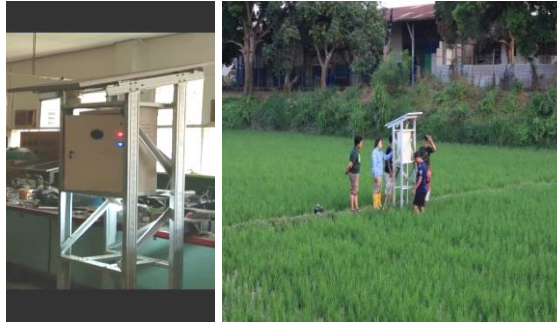
Gambar 4. Alat ultrasonik pengusir hama padi dan pemasangannya
