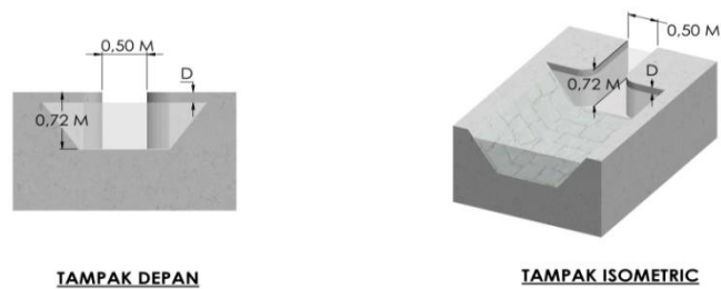
Gambar 4. Desain Bangunan Ukur (Pintu Bangunan 2 Kanan)
