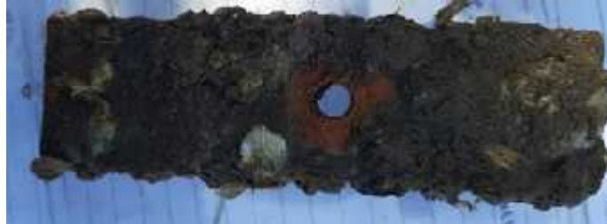
Gambar 9. Spesimen 1 Fe (pelindung lilin) minggu keenam
