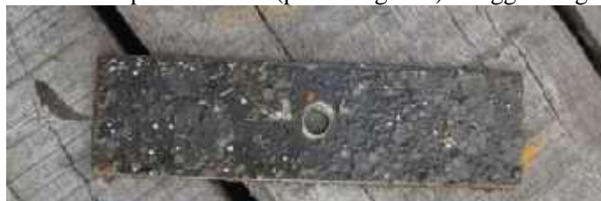
Gambar 4. Spesimen 1 Fe (pelindung lilin) minggu ketiga
