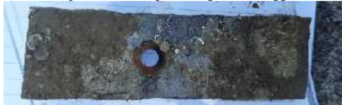
Gambar 10. Spesimen 2 Al (pelindung minyak) minggu keenam
