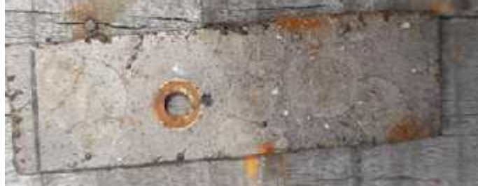
Gambar 7. Spesimen 3 Al (pelindung lilin) minggu ketiga
