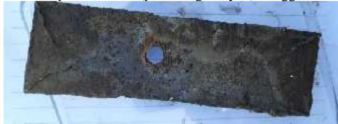
Gambar 12. Spesimen 3 Al (pelindung lilin) minggu keenam
