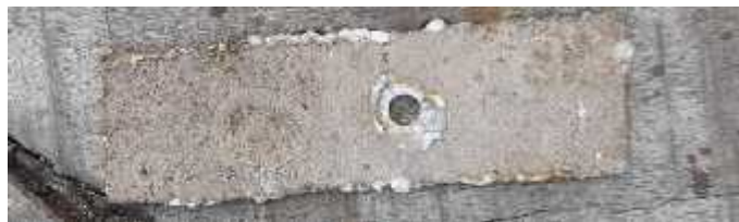
Gambar 3. Spesimen 1 Al (pelindung lilin) minggu ketiga
