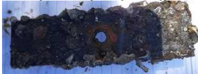
Gambar 13. Spesimen 3 Fe (pelindung lilin) minggu keenam
