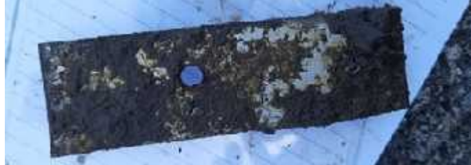
Gambar 8. Spesimen 1 Al (pelindung lilin) minggu keenam
