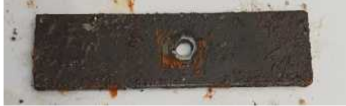
Gambar 6. Spesimen 2 Fe (pelindung minyak) minggu ketiga
