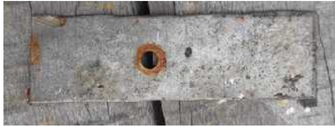
Gambar 5. Spesimen 2 Al (pelindung minyak) minggu ketiga
