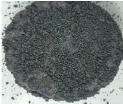
**Gambar 6.** Sampel C Setelah di Uji Kuat Tekan
