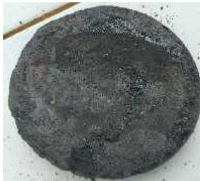
**Gambar 4.** Sampel A Setelah di Uji Kuat Tekan
