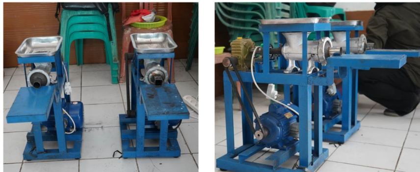
Gambar 2. Teknologi pencetak briket sekam padi
