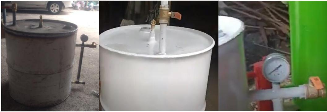
Gambar 3. Tabung steam dengan *pressure relief valve* dan *preassure gauge*
