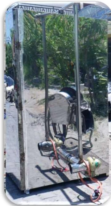
**Gambar 4.** Mesin pengering kerupuk
