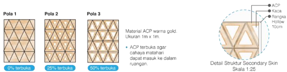
Gambar 13. Detail Secondary Skin Sumber: Dokumentasi Pribadi, 2023
